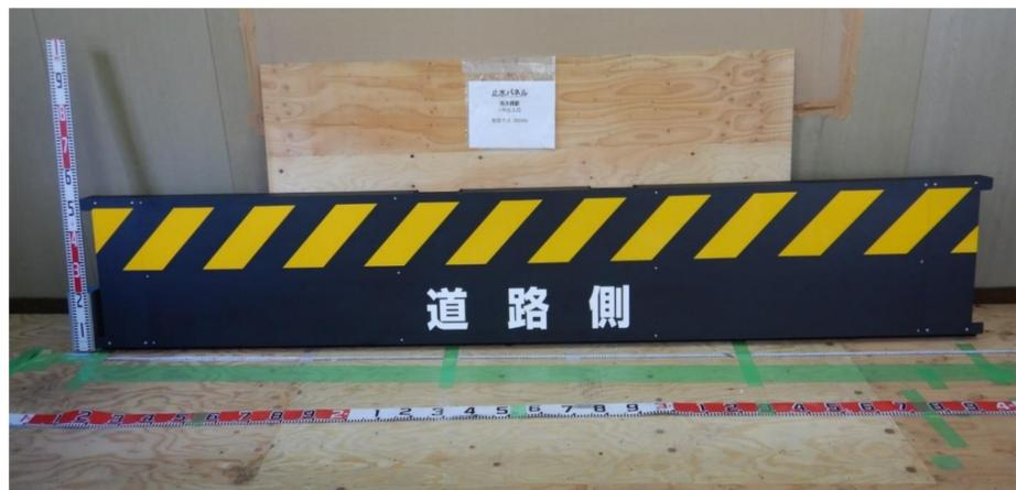
内層をアルミハニカム、外面をCFRP(炭素繊維強化プラスチック)で覆う構造により従来のアルミ製止水板より軽量化を実現。
